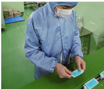
熱さまシートの目視検査
