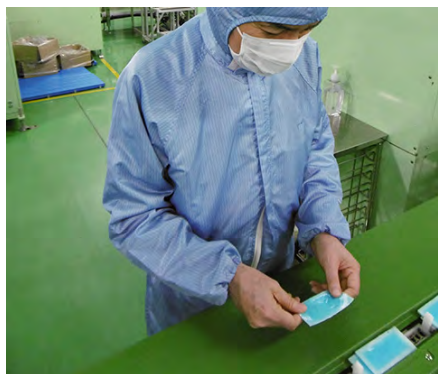
熱さまシートの目視検査
